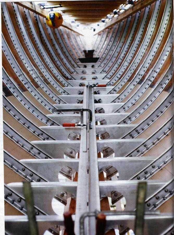
Edelmetall. Stück für Stück wurden die alten vom Rost zerfressenen Spanten durch neue ersetzt. Oliver Berkling (r.) war es, der sich unbeirrt für den Erhalt des Zwölfers einsetzte
