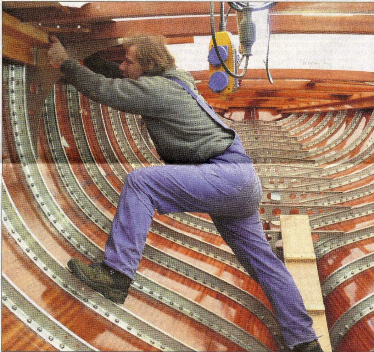
Sämtliche 53 Spanten der „Sphinx“ musste die Handwerker-Crew um Kai Wohlenberg ersetzen und neu aus Niro-Stahl formen, um das Schiff anschließend im Unterwasserschiff neu zu beplanken. Fotos privat
