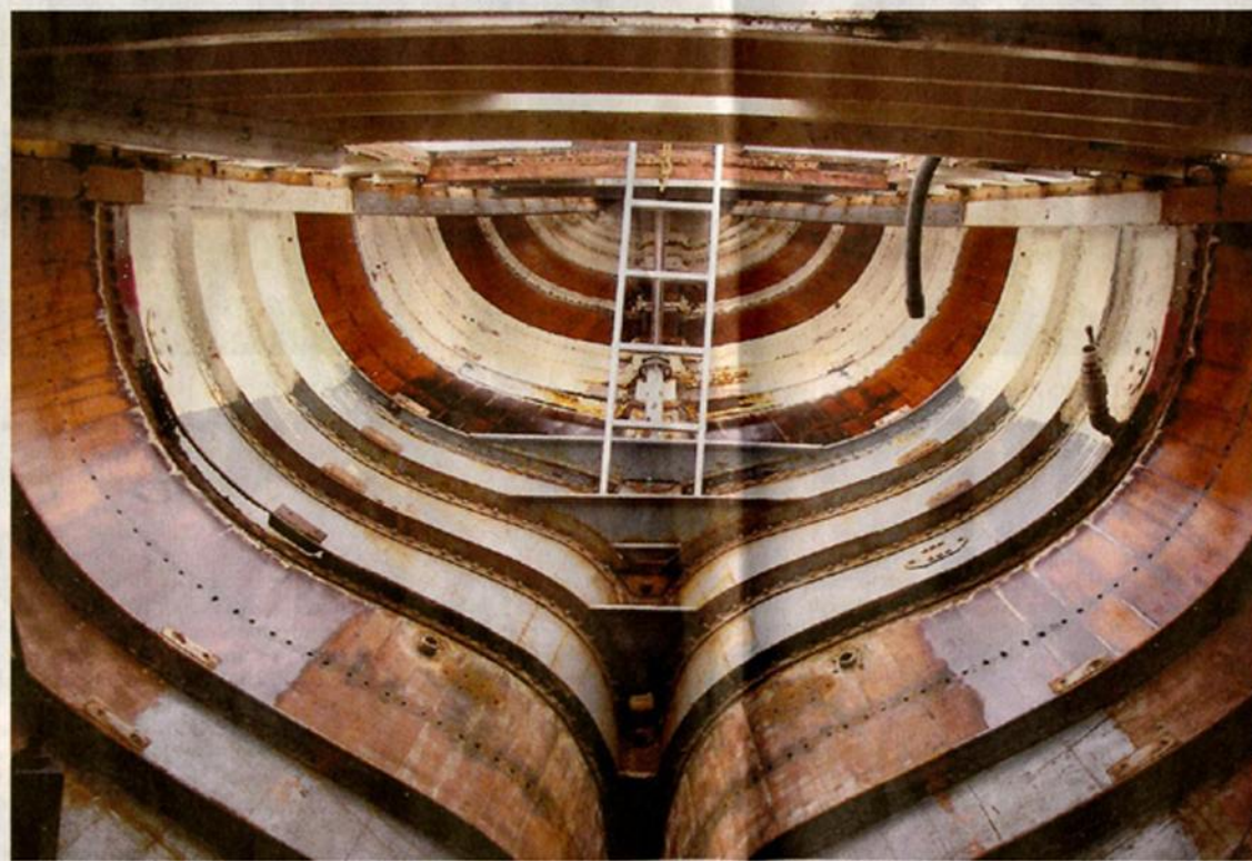
Im Bauch des Bootes: Blick auf die Stahlspanten der „Sphinx“ – Berking und seine Freunde nahmen die alte Jacht fast komplett auseinander
